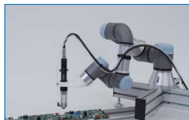
Ứng dụng Universal robot và ViscoTec Spray phun lớp bảo vệ bản mạch
