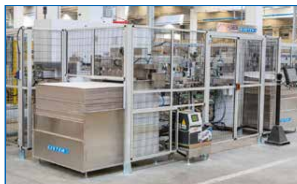
Hệ thống đóng gói gạch linh hoạt
