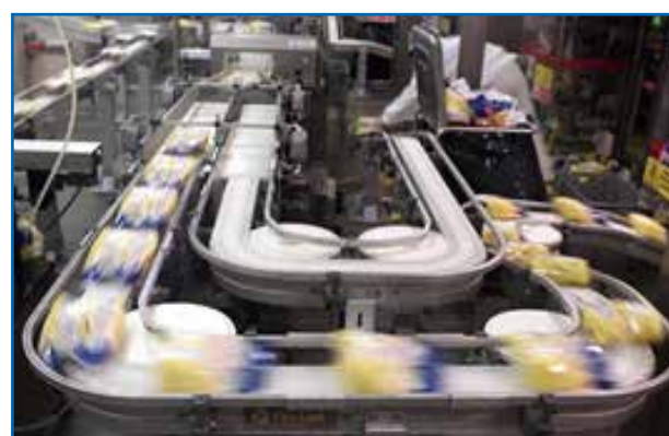
Băng tải tốc độ cao trong ngành thực phẩm với góc cong hình chữ U và chữ S
