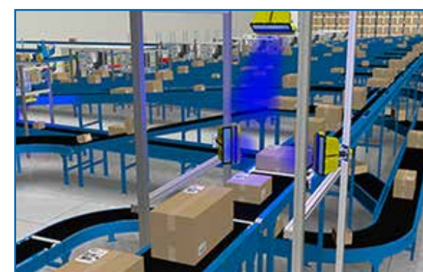
Hệ thống kiểm tra mã vạch và phân loại thùng tự động
