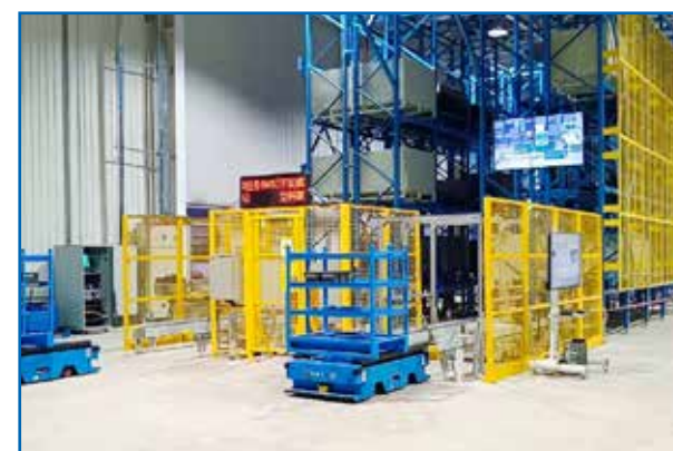
Hệ thống Truck AGV dẫn đường bằng băng từ
