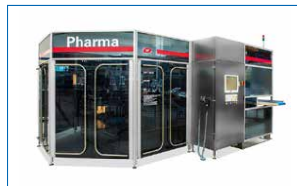
Máy kiểm tra quang học cho túi dược phẩm
