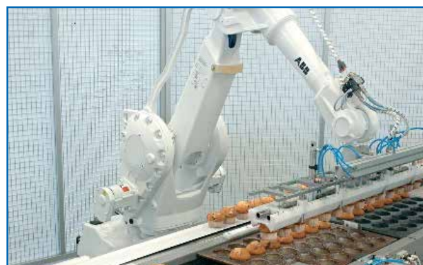
Robot tự động gấp bánh vào khay
