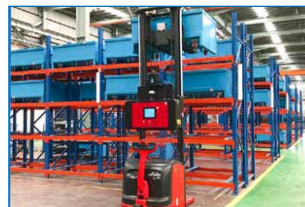
Hệ thống Forklift AGV tự dò đường bằng Laser
