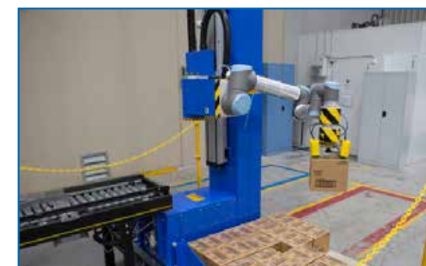
UR10 với thiết kế chân đế dạng Zero có thể xếp 2 pallet
