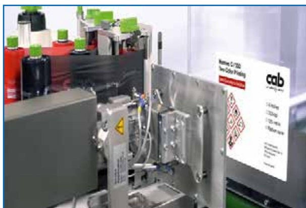
Hệ thống in dán tem nhãn tự động
