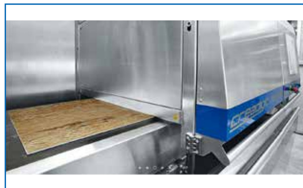
Hệ thống in phun gạch độ phân giải cao
