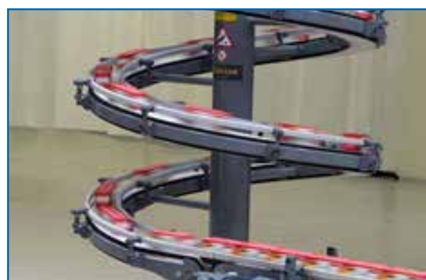
Hệ thống băng tải Spiral Elevator đưa sản phẩm lên cao giúp tiết kiệm không gian
