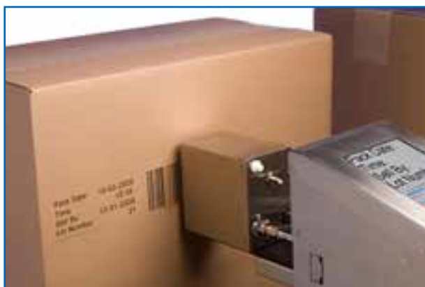
Hệ thống in phun mã code, thông tin sản phẩm khổ rộng
