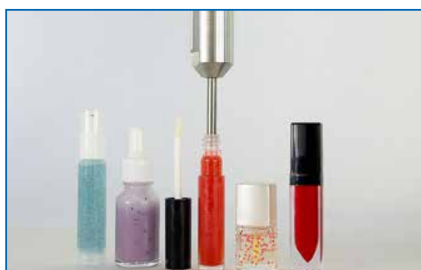
Hệ thống có thể chiết rót nguyên liệu có độ cứng tới 7.000.000 cps/mPas
