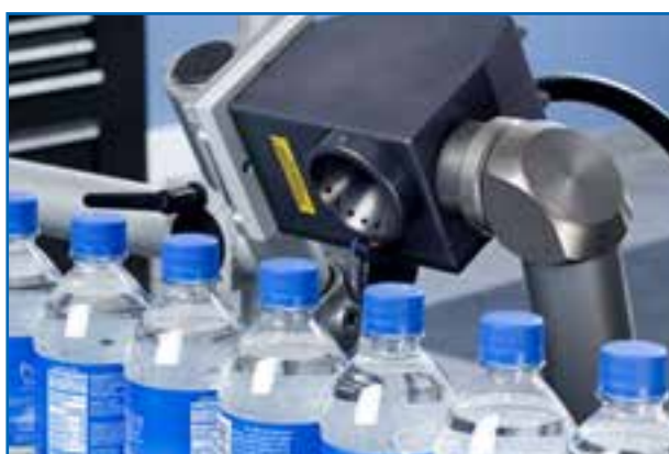
Hệ thống khắc laser HSD trên vỏ chai nước lọc tốc độ cao
