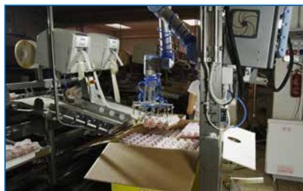
Ứng dụng Universal Robot tự động đóng thùng trứng
