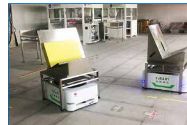
Hệ thống Dragging AGV dẫn đường bằng Barcode
