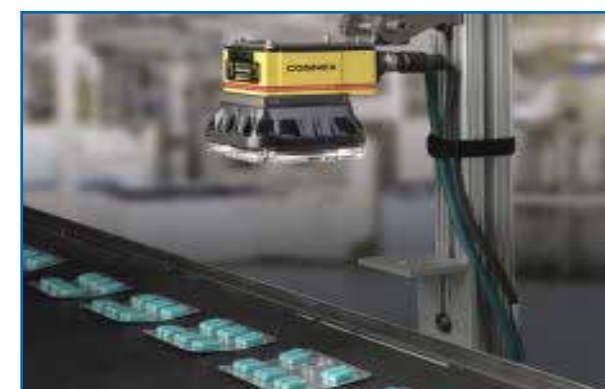
Hệ thống kiểm tra viên nang tự động
