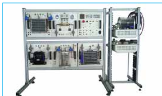
Mô hình lắp đặt các chu trình lạnh cơ bản
