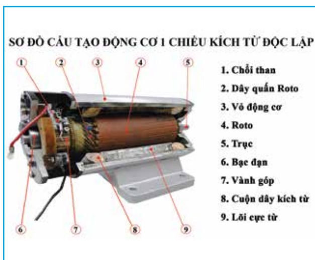
Mô hình cắt bỏ động cơ điện
