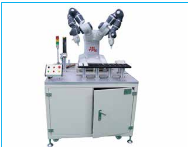
Trạm sản xuất linh hoạt sử dụng Cobot Yumi - ABB
